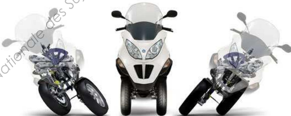
Il est doté à l'avant d'une suspension à quadrilatère articulé lui permettant d'avoir une inclinaison importante et un maximum de flexibilité dans toutes les conditions d'usage.
