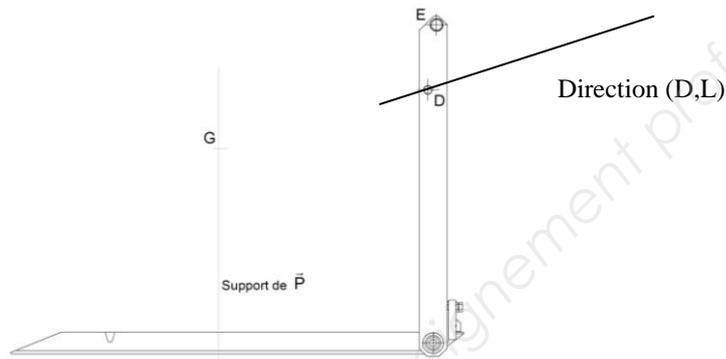
L'étude de l'équilibre du bras supérieur S5 par l'outil informatique a permis de déterminer la norme et le sens de l'action mécanique en E dans le cas d'une poussée maximale du vérin :
