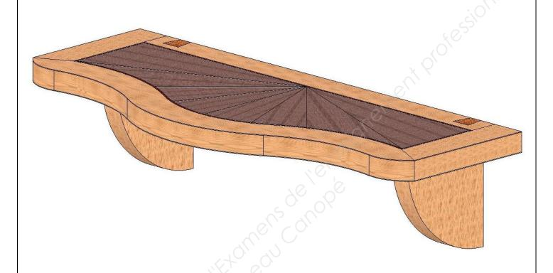
Un client vous demande de réaliser <u>cette tablette d'entrée</u>. Celle-ci se compose d'un dessus et de deux consoles.
