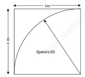
Pour les candidats ne présentant que l'épreuve E3 : Prévoir un support fixé au mur à 50 cm de hauteur du sol plan et carré de 1 m  $\times$  1 m de côté Tracer un arc de cercle de 99 cm de rayon limite de l'ouvrage de l'épreuve E3
