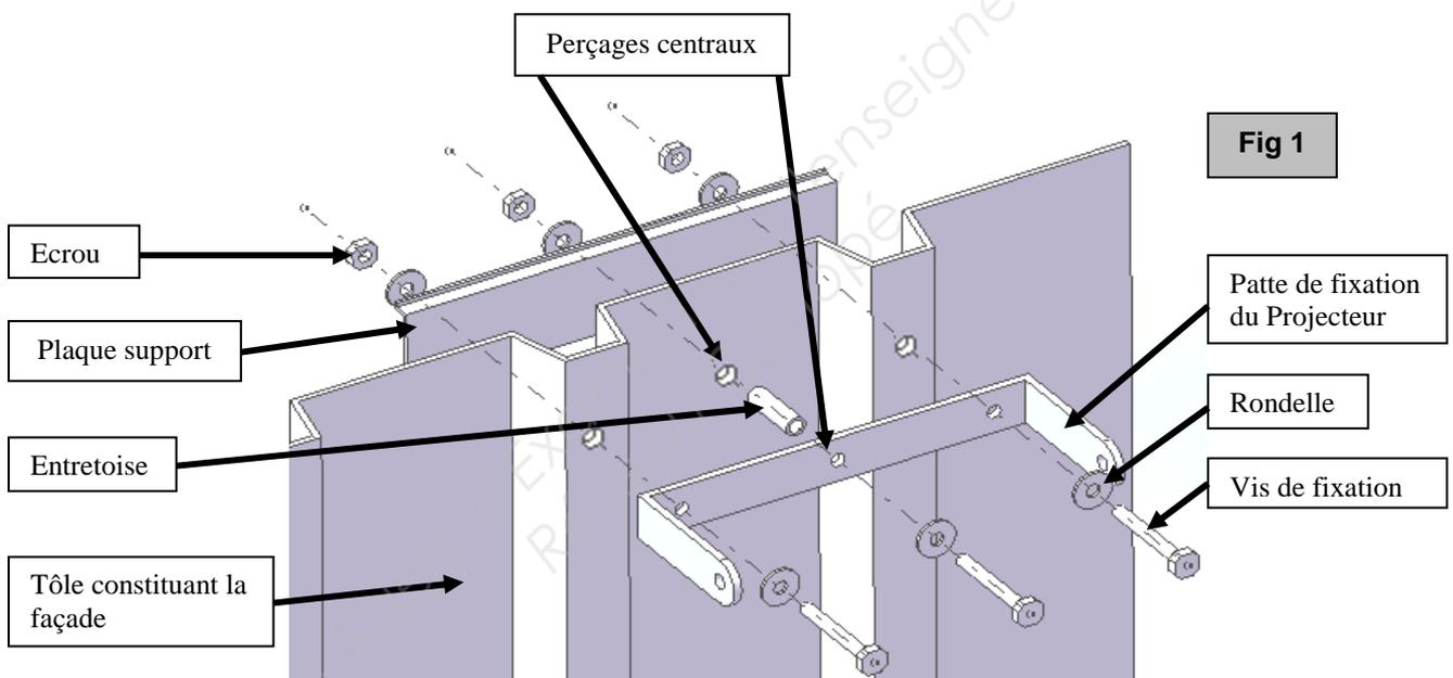
**C-1 Déterminer** le diamètre du trou de passage de la vis de fixation dans la patte.
