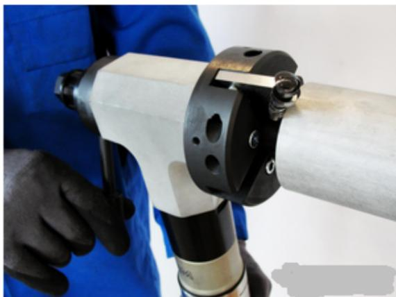
La machine à chanfreiner portable modèle US25 est conçue pour le chanfreinage, le dressage, le débardage, le détubage, la mise à longueur de pipes et tubes de diamètre intérieur 25 mm jusqu'à un diamètre extérieur de 90 mm. Le plateau porte-outil peut être équipé de 4 portes outils permettant de réaliser individuellement ou simultanément différents usinages.
