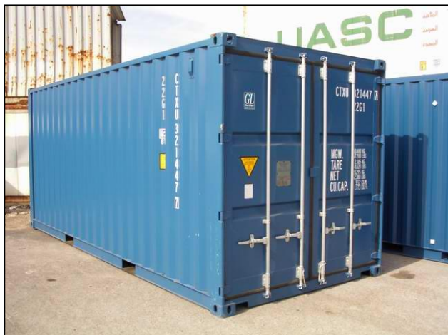
Figure 1 Container maritime de 40 pieds: de longueur L = 12,01 m, de largeur l = 2,33 m et de hauteur h = 3,00 m.
