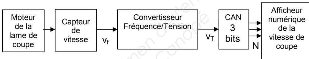
Le signal  $v_f$  fourni par le capteur de vitesse a une fréquence  $f$  proportionnelle à la fréquence de rotation  $n$  du moteur de la lame en tr/s.
