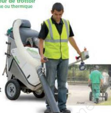
Cet outil de propreté est capable d'aspirer la plupart des déchets encombrant les trottoirs et caniveaux.
