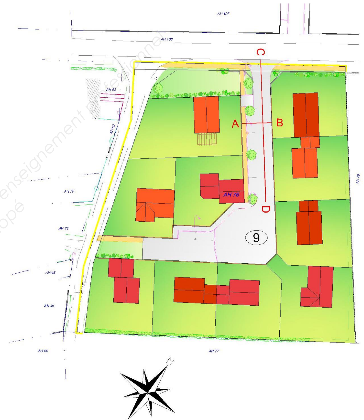
Situation du Profil en Travers (AB) et du Profil en Long (CD) (sans échelle)
