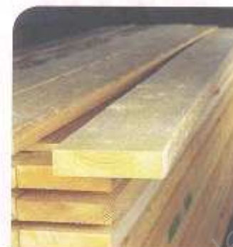
SOLIVETTE : • section 40 x 160 mm qualité charpente traitée de 3 m à 7 m (longueur possible jusque 8 m), • section 40 x 200 mm qualité charpente traitée de 3 m à 6 m (longueur possible jusque 8 m).
