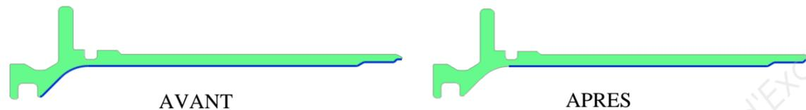
6-1-2 Recalculez toutes les trajectoires d'usinage. Procédez à la simulation de l'opération « finir profil intérieur » de la surface 6 en présence de l'examineur.
