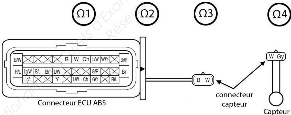
Question 2.4 : sur le schéma ci-dessus, connecter les ohmmètres  $\Omega 3$  et  $\Omega 4$  pour vérifier l'isolement avec la masse des deux fils du faisceau « connecteur capteur – capteur ».
