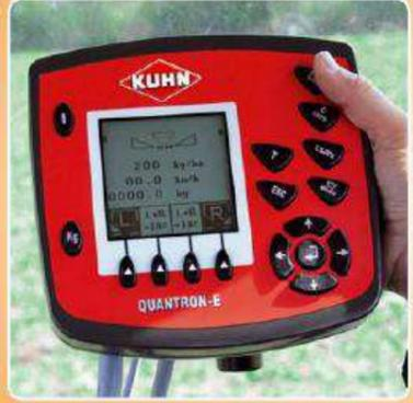
Le boîtier QUANTRON E s'utilise avec une machine équipée d'un D.P.A.E. (Débit Proportionnel à l'Avancement Electronique) ou d'une pesée intégrée (AXIS W).
