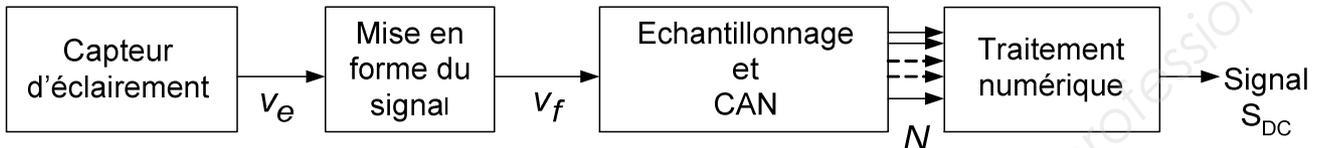
La carte électronique gérant la fonction « contrôle de luminosité » transmet un signal  $S_{DC}$  à la carte maître dans le but de modifier la luminosité des pixels en fonction de l'éclairement lumineux (**documentation SP3**).
