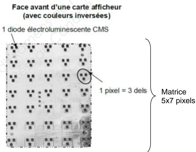
Lors des tests finaux d'un système d'affichage, un niveau de puissance est déterminé pour chaque pixel afin d'assurer une luminosité optimale et identique pour tout l'ensemble. Un niveau correct est un niveau qui permet la lecture sans être trop agressif non plus. Ensuite, avec les années de service qui passent, en fonction de la courbe d'évolution de la luminosité des DELs, la puissance fournie à chaque pixel évolue afin de conserver une luminosité stable.
