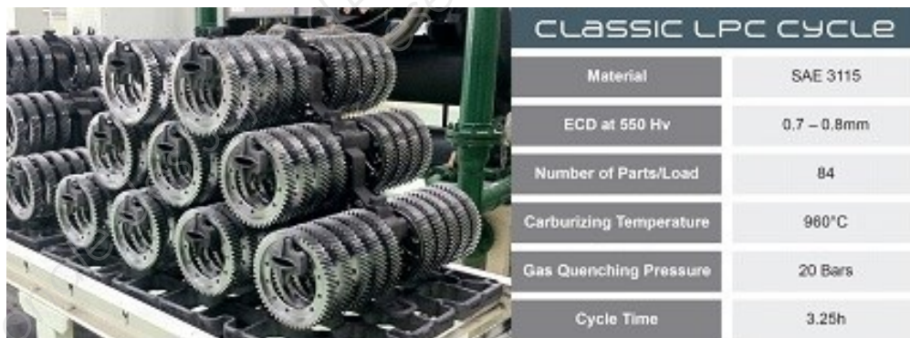
Fig. 3 : Charge de couronnes pour four de CBP
