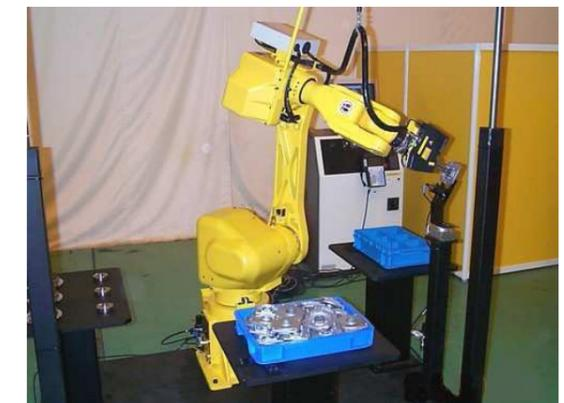
À l'image du bras de l'homme, un robot industriel est la plupart du temps composé de 6 axes (6 degrés de liberté)
