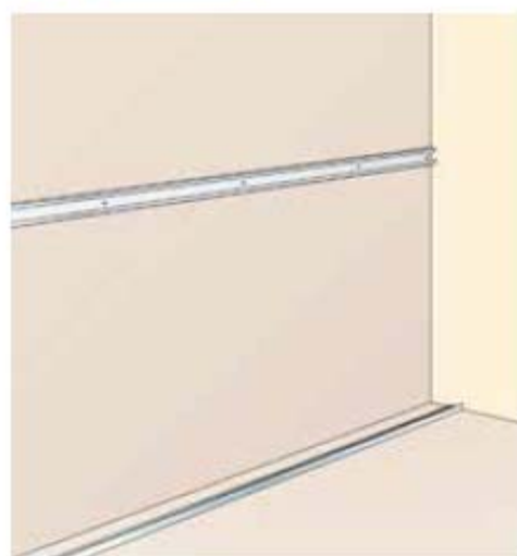
Figure 1 : pose des lisses Clip'Optima et de la fourrure murale Optima.
