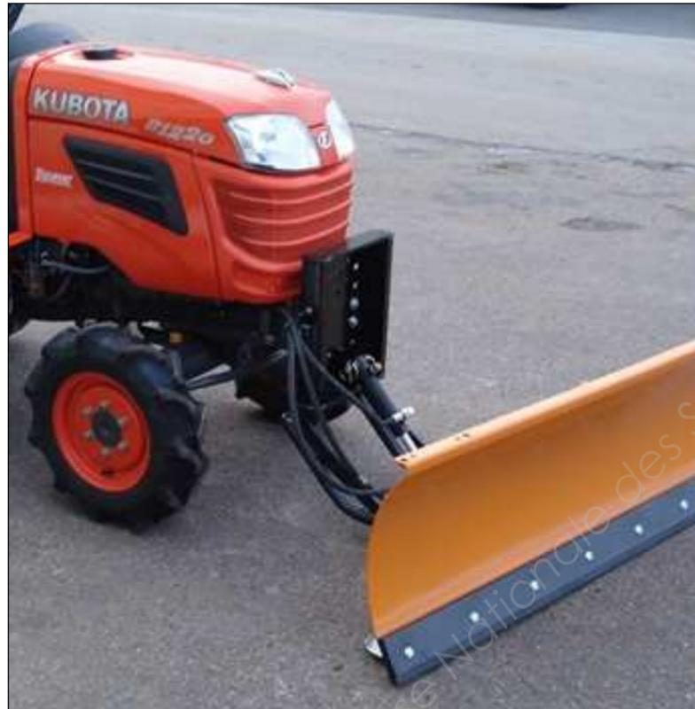
Exemple: montage universel avec lame de 1300 mm
