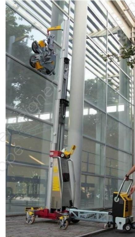
PALVAC « MAGNUM » lève des charges jusqu'à 500 Kg et jusqu'à 4800 mm, avec une structure (760\*840\*1740 mm) des plus réduite et légère que l'on peut monter et démonter en 5 minutes à l'aide de seulement deux opérateurs.
