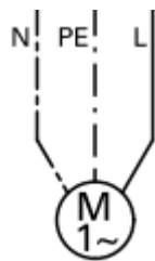
Circulateur circuit de chauffage sans régulation ECS
