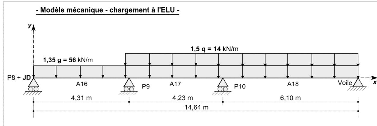
Sachant que le moment sur appui en P9 vaut -83,9 kN.m, calculer le moment sur appui P10.
