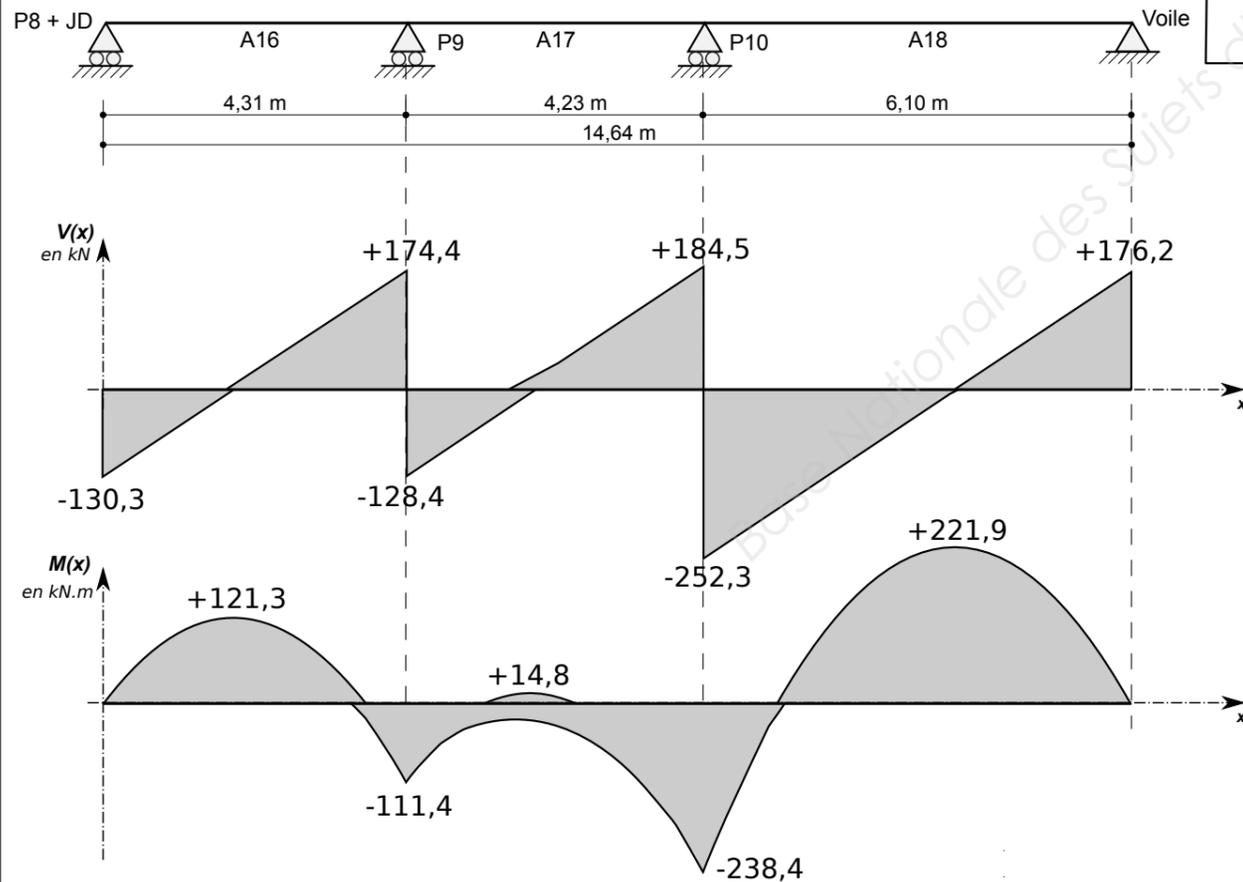
2 Courbe enveloppe donnée par un logiciel de béton armé (à utiliser pour les questions Q19, Q20 et Q21)
