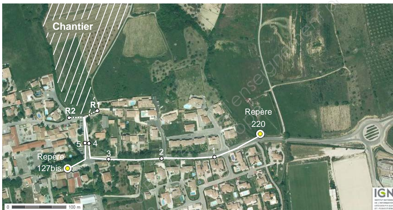
Schéma du cheminement altimétrique effectué d'après une photographie aérienne du site (issue de geoportail.gouv.fr)
