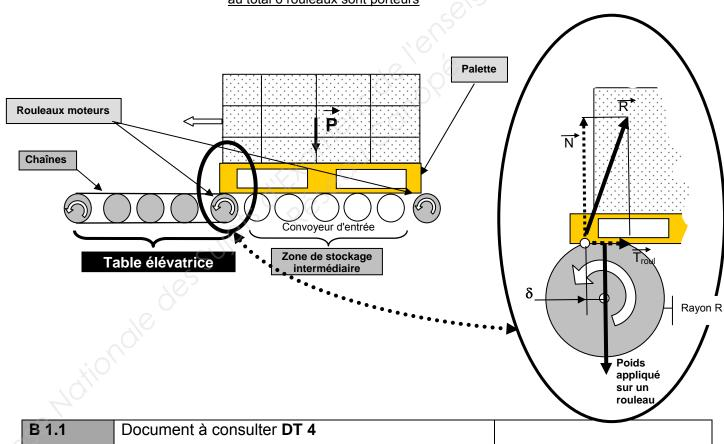
**Calculer** l'effort T<sub>roul</sub> nécessaire pour vaincre la résistance au roulement sur un rouleau moteur.
