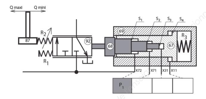
Question 13 : sur le document réponse DR3 représenter et nommer les actions mécaniques qui agissent sur l'ensemble piston 68 et tiroir 92 (les pistons 68 et 67 ne sont pas en contact sur la face d'appui).
