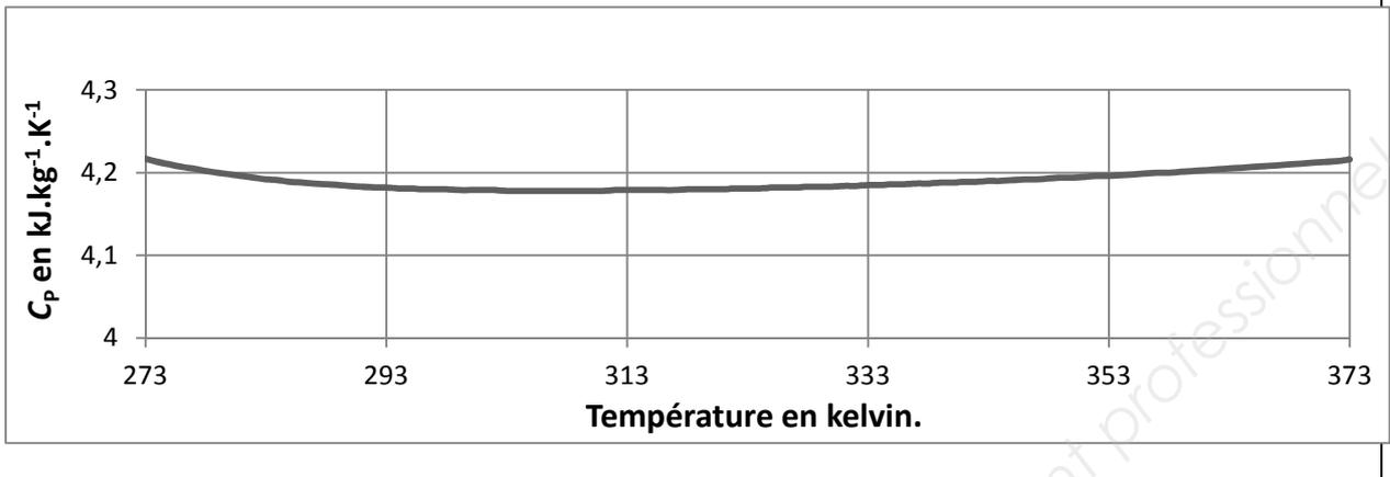
**Document 2-3** : évolution de la capacité thermique massique  $C_p$  du glycol en fonction de la température
