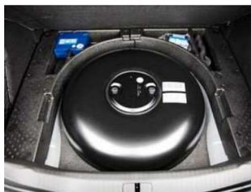
Les dimensions du réservoir étudié sont : diamètre 700 mm, hauteur 250 mm. Il peut contenir 80 L de GPL liquide à la température de 15°C. La phase gazeuse occupe le reste du réservoir. La pression de celle-ci est de 5 bars. Une soupape de sécurité permet d'évacuer le gaz avec un débit de  $18 \text{ m}^3 \cdot \text{min}^{-1}$  si la pression dans le réservoir atteint 27 bars.
