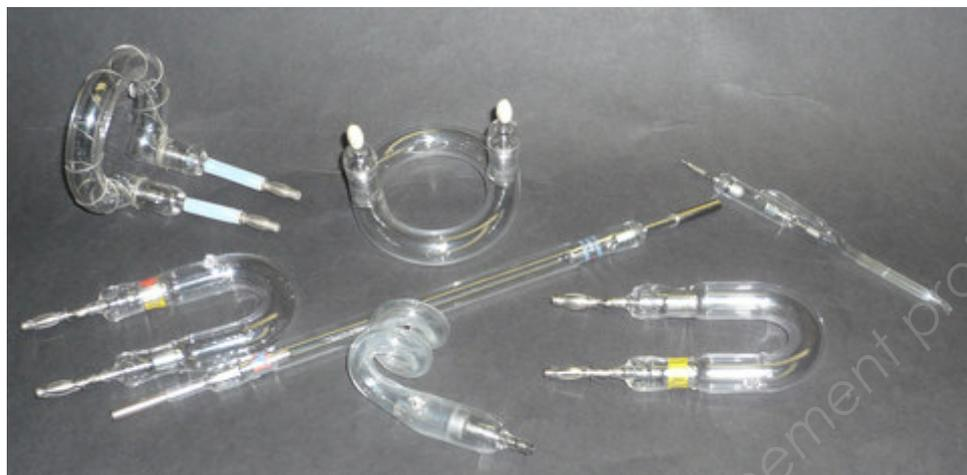
*La technique de fabrication des lampes flash se prête à une grande variété de formes. Les tubes linéaires, circulaires et hélicoïdaux correspondent à des applications spécifiques.*
