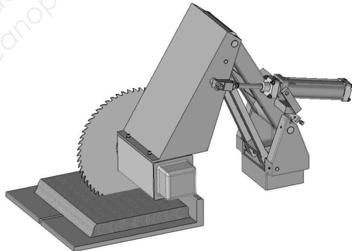
Une entreprise souhaite élargir sa gamme de scie pendulaire. Cette étude a pour objectif de définir le vérin actionnant le mécanisme de va-et-vient de la lame de scie, notamment la course de sa tige, le diamètre de son piston ainsi que le diamètre de l'axe permettant de lier la tige au bras.
