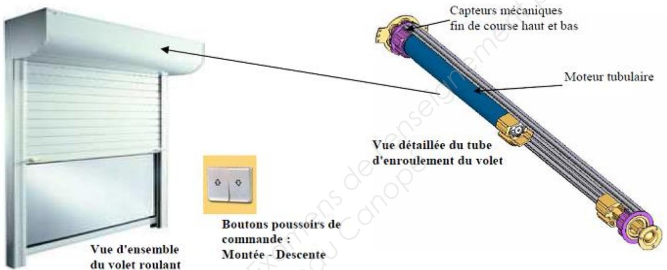
Vous devez installer l'alimentation et la commande des volets roulants du local. Le choix s'est porté sur une centralisation de la marque Euromatik. Un interrupteur à commande radio sera installé à proximité de chaque volet roulant et une télécommande radio programmable commandera l'ensemble des volets roulants.
