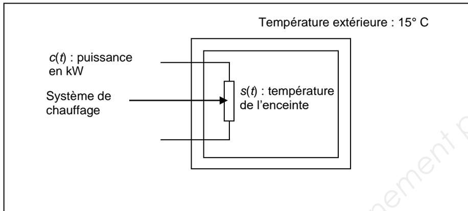
On note  $c(t)$  la puissance de chauffe en kW à l'instant  $t$  et  $s(t)$  la température à l'intérieur de l'enceinte à l'instant  $t$ .
