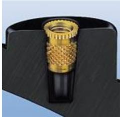
L'insert fileté est inséré à chaud dans la pièce plastique. Celle-ci se ramollit et épouse parfaitement la forme de l'insert métallique. Après refroidissement du métal et du matériau plastique, l'assemblage montre une grande robustesse.
