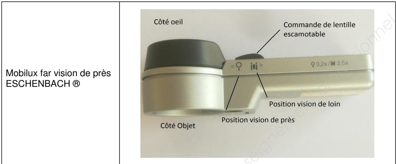
Cet instrument est composé d'une lentille mince  $L_1$  fixe et d'une lentille mince  $L_2$  escamotable (cf.photo ci-dessus).
