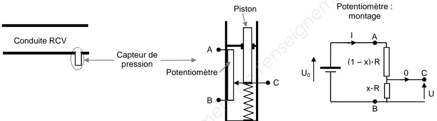
Le fluide dans le circuit RCV, en exerçant une pression sur le piston du capteur, déplace le curseur du potentiomètre ce qui a pour effet de faire varier la tension  $U$ .
