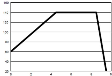
Montée en température : 0,3°C/min
