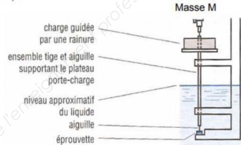
On soumet, par l'intermédiaire d'une tige à extrémité plate (section droite de 1 mm<sup>2</sup>), une éprouvette à un effort de compression constant  $F$  dû à la masse additionnelle  $M$ . La température de cette éprouvette s'accroît linéairement de **50 (± 5) ou 120 (± 10) °C/h**.
