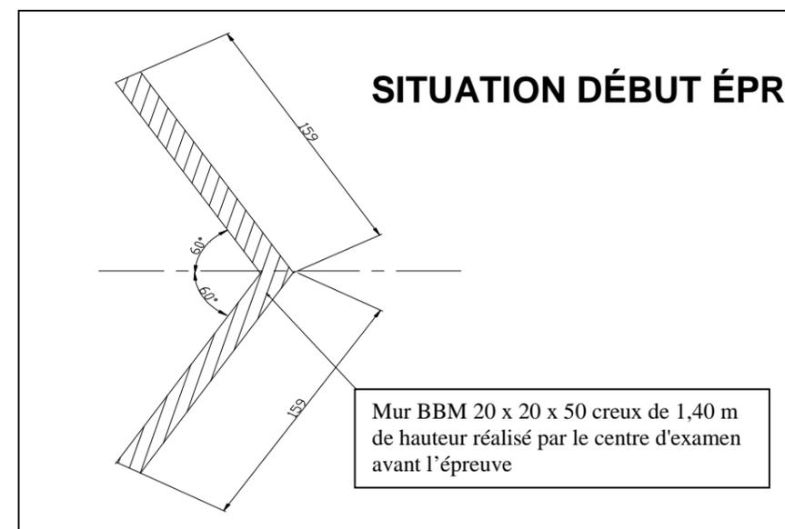
Mur BBM 20 x 20 x 50 creux de 1,40 m de hauteur réalisé par le centre d'examen avant l'épreuve
