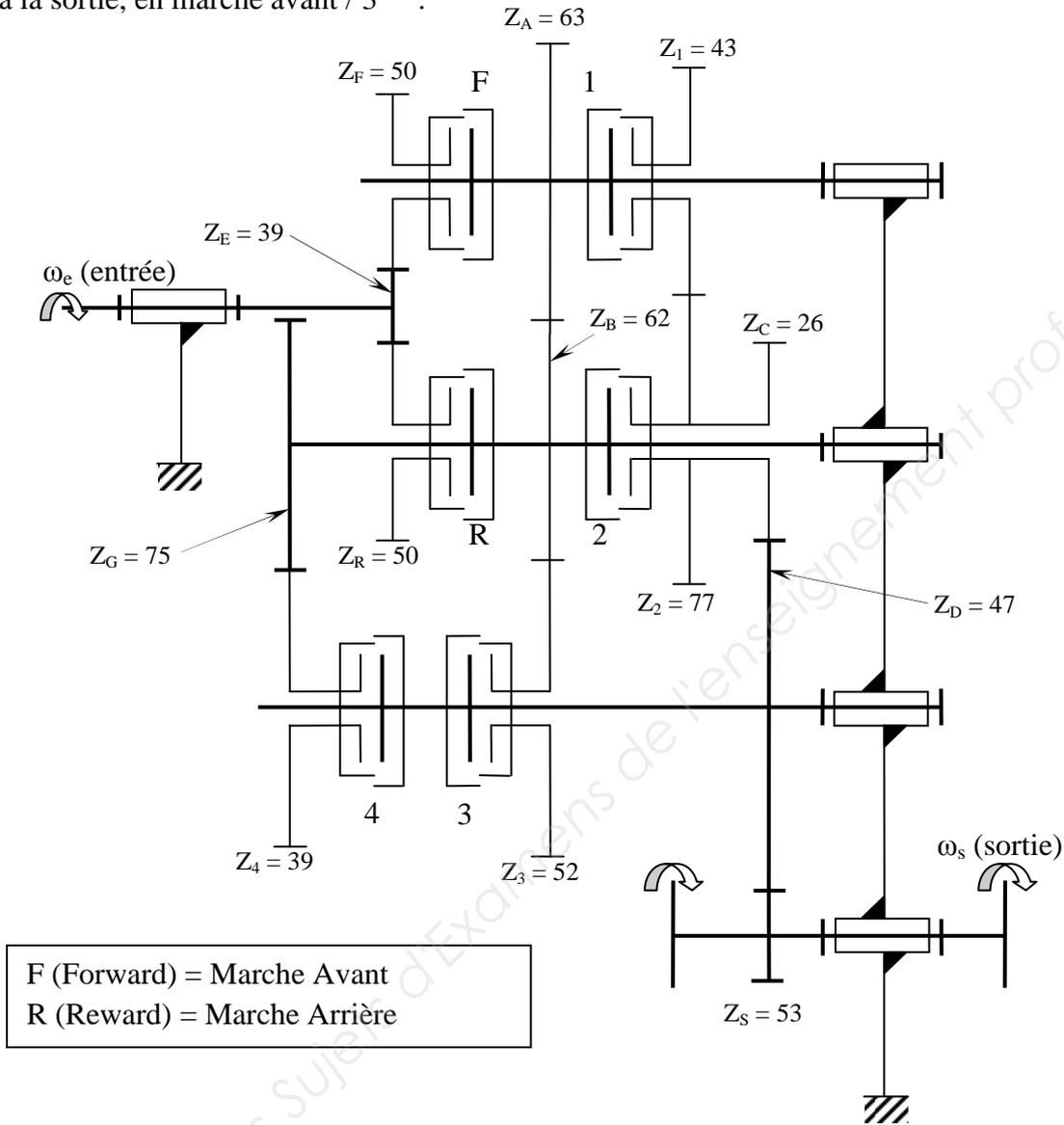
**Question 9 :** En observant le schéma cinématique précédent, comparer le sens de rotation de l'arbre de sortie par rapport à celui d'entrée en marche avant / 3<sup>ème</sup> (cocher la bonne réponse) et justifier :
