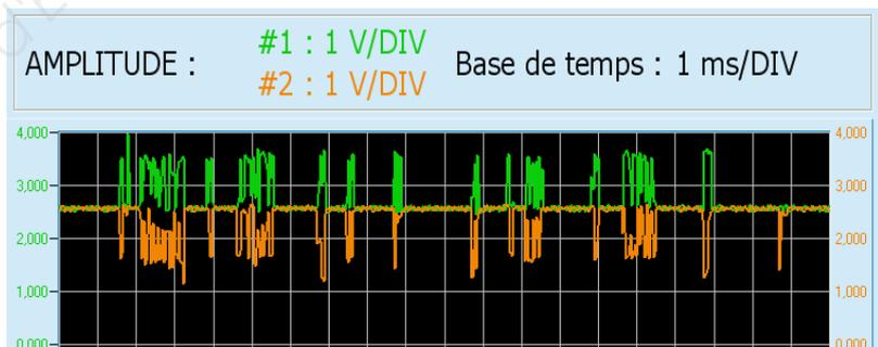
La ligne CAN H donne des informations entre 3,5 volts et 2,5 volts, la ligne CAN L donne des informations entre 2,5 volts et 1,5 volts.
