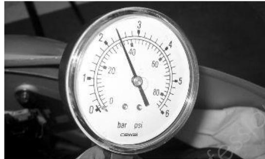
La tension de batterie étant > 12 V, vérifier le débit de la pompe en débranchant le tuyau du manomètre de l'injecteur. Préparer un récipient gradué ayant une capacité d'environ 1 L. Faire tourner la pompe au moyen des diagnostics actifs de l'ordinateur de poche. Étrangler le tuyau de carburant à l'aide d'une paire de pinces à becs longs, en stabilisant la pression près d'environ 2,5 bars. Vérifier qu'en 15 secondes la pompe ait un débit d'environ 110 cm<sup>3</sup>.
