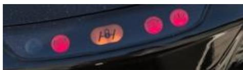
Dans le cas d'un dysfonctionnement du système d'injection, le témoin s'allume et le système fonctionne alors en mode dégradé.
