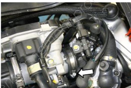
Installer l'outil spécifique de contrôle de la pression du carburant et positionner le collecteur sur un récipient gradué d'au moins 100 cm<sup>3</sup>. Brancher l'injecteur avec le câble fourni pour le testeur d'injection.
