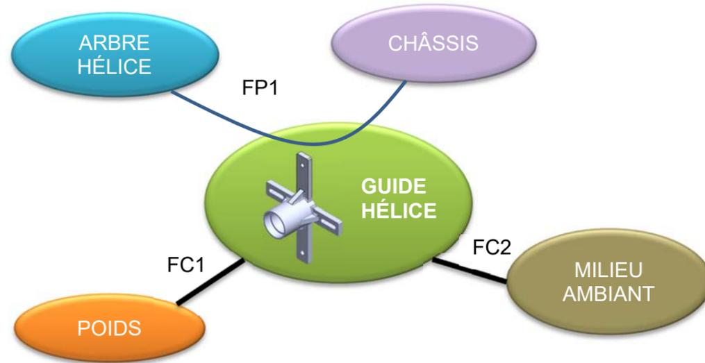
FP 1 : Guider en rotation l'arbre hélice par rapport au châssis
