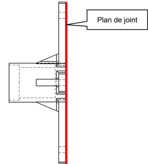
ÉTAPE 4 : MISE EN PLAN DU GÉOMÉTRAL DU GUIDE HÉLICE
