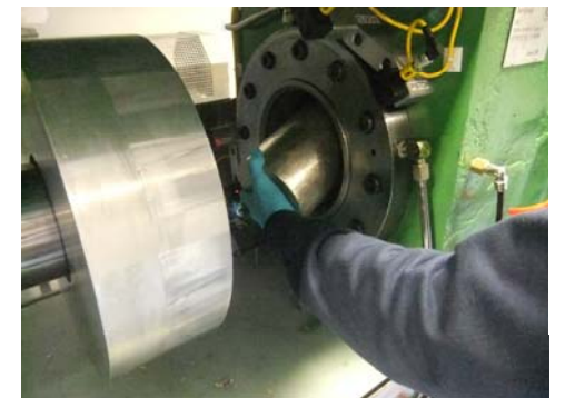
Mise en place du Cylindre « Bille » de lithium dans l'extrudeuse
