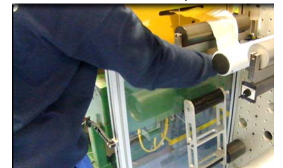
Prise en main de la bande de lithium en sortie d'extrusion pour début d'enroulement
