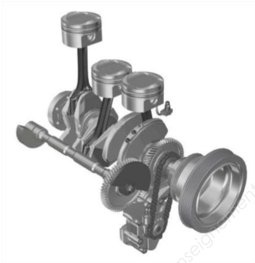
Pour maîtriser au mieux les vibrations inhérentes à un « 3 cylindres », l'EB turbo possède un arbre d'équilibrage relié au vilebrequin par un engrenage, ainsi qu'un double volant amortisseur.
