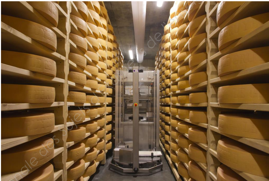
Fig 1 : Robot de soins dans le couloir entre 2 rangées de meules de fromage
