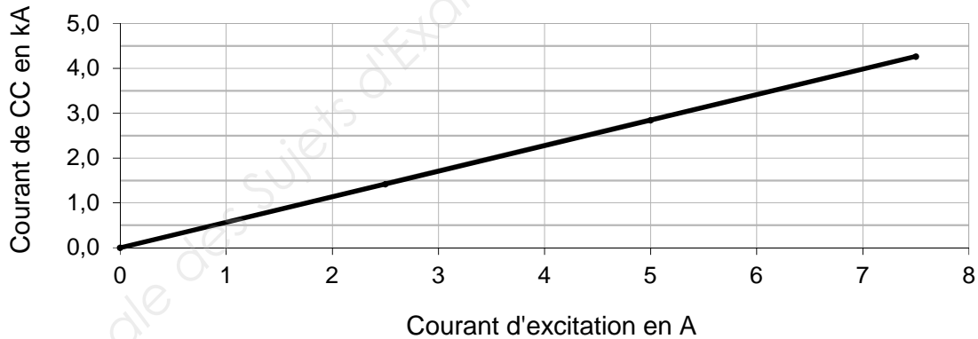
Courant de court circuit dans un enroulement en fonction du courant d'excitation
