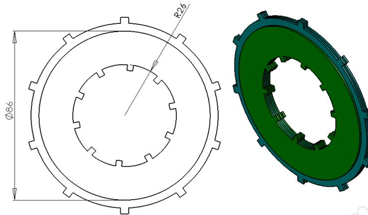
On donne :  $C_{trans} = n * \mu * F_{presseur} * R_{moy}$
