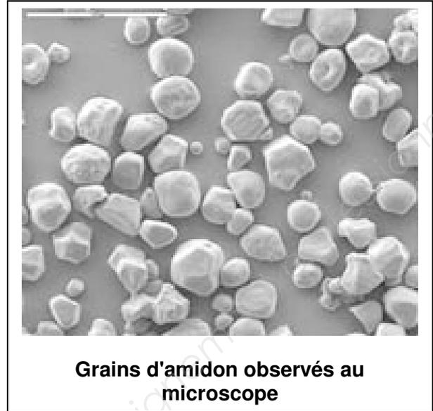
Grains d'amidon observés au microscope
