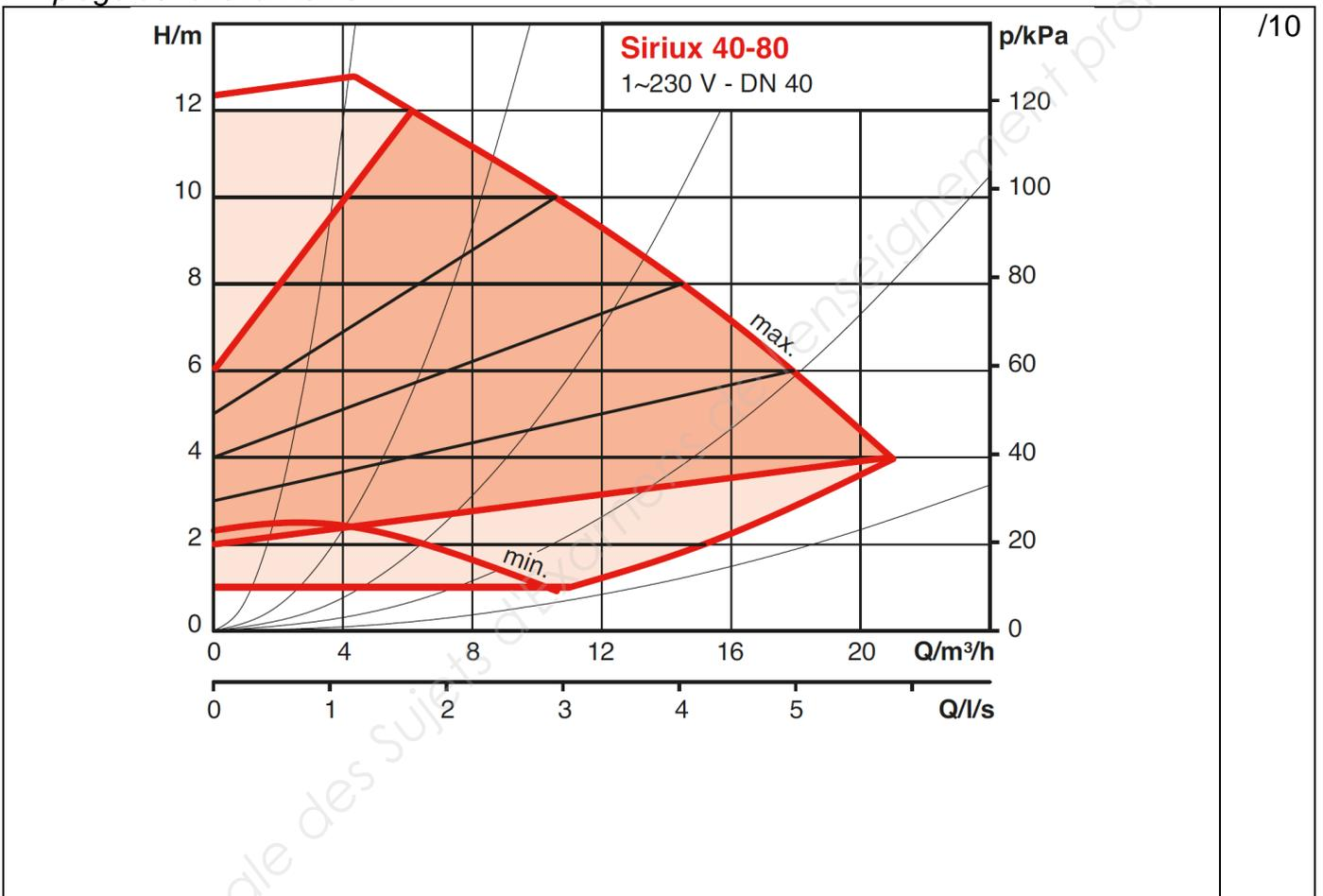
k. Vérifier si le circulateur livré peut être monté sans modifications au réseau hydraulique. Justifier votre réponse.
