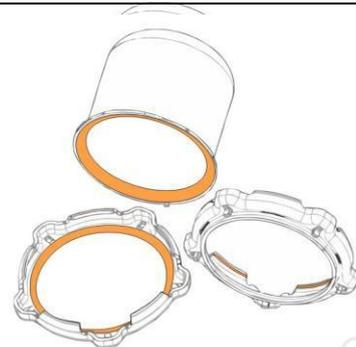
Étaler une fine couche de graisse sur les surfaces de contact. Utiliser la graisse recommandée par le constructeur VOLVO 85108974.
