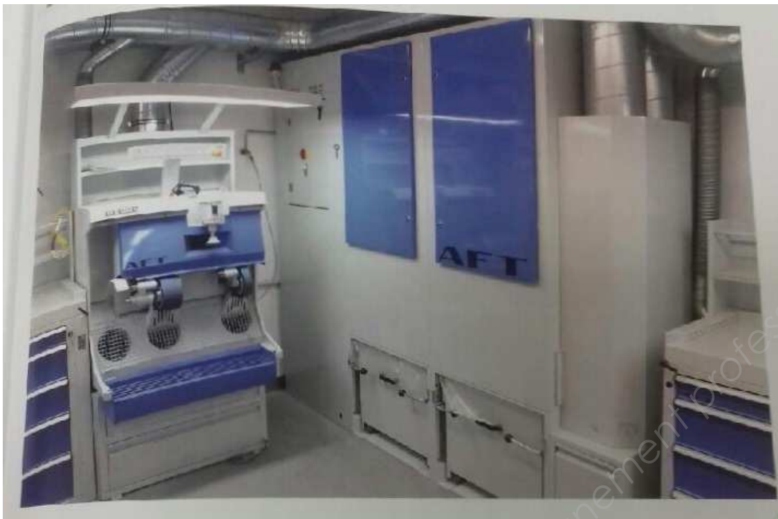
Banc de finition avec système d'aspiration
