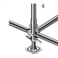
(4) Emboîtez les montants, puis, à la hauteur de 2,00 m, raccordez un support plancher en U et des planchers standards munis de joints de sécurité, avec une moise longitudinale.
