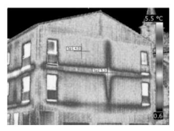
On observe que les ponts thermiques, qui correspondent aux zones foncées, se situent principalement à la jonction entre les murs de refends et les murs extérieurs et à la jonction entre les planchers et les murs extérieurs.
